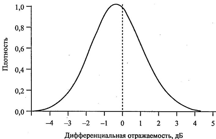
Рис. 3.30. Диаграммы калибровки  $Z_{DR}$ , полученные по солнечной радиации, наблюдавшейся на радиолокаторе Trappes [10].
