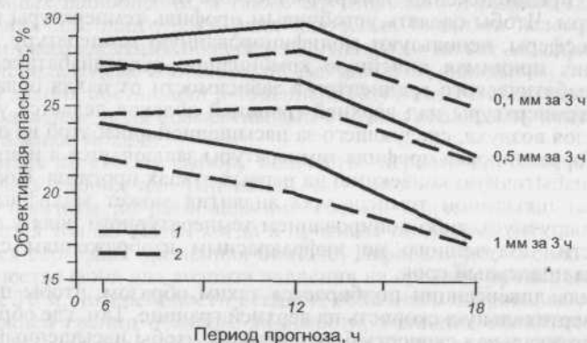
Рис. 8.2.2. Эффект ввода радиолокационных данных об осадках в рабочую мезомасштабную модель Великобритании [14]. Использованы 25 прогнозов обложного дождя (лето 1997 г.). Радиолокационные данные накапливались за 3 ч. 1 — наблюдения, 2 — нет радиолокационных данных.
