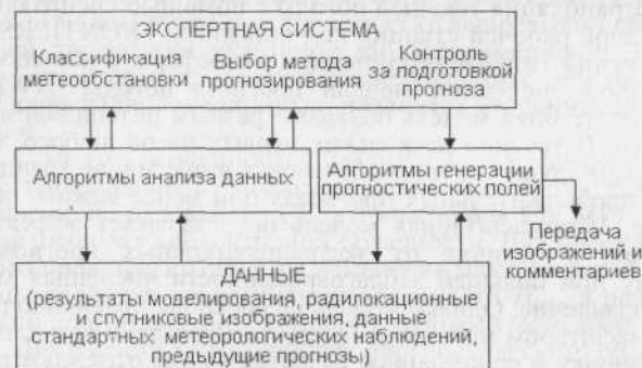
Рис. 8.2.1. Предполагаемая структура системы прогнозирования осадков с искусственным интеллектом [20].
