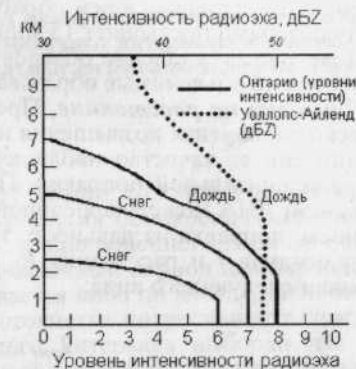
Рис. 4.4.4. Отражаемость и интенсивность радиоэха в зависимости от высоты для Уоллопс-Айленда, Вирджиния, и для бассейна озера Онтарио [15].
