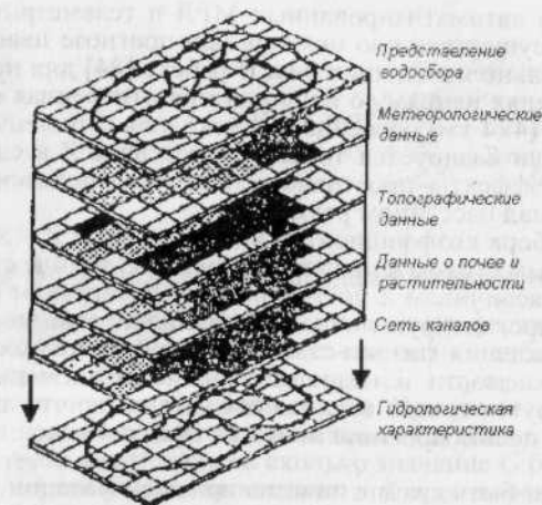
Рис. 8.6.2. Многослойная имитация распределенной модели на сетке [11].
